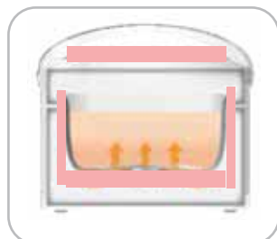
Calore dal fondo, dalle pareti e dall'alto Mechanical heater on the bottom, side and top
